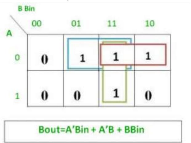
$$B_{out} = \overline{A} B + (\overline{A} + B) B_{in}$$
